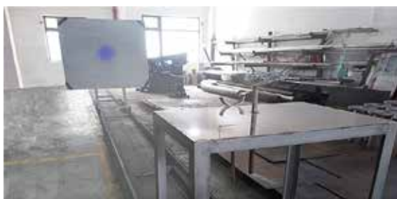
50米雷达物位计产品标定线
